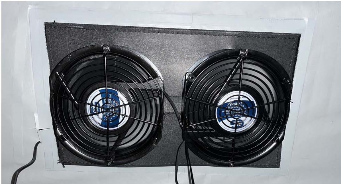
9. Con l'adattatore CA esterno al dispositivo, far passare il cavo di alimentazione attraverso l'apposita fessura e collegarlo alla ventola. (non collegare ancora una presa elettrica poiché è necessario installare prima il filtro)
